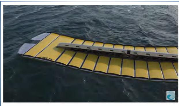
Además, el dispositivo puede fabricarse con plásticos y plásticos reforzados que no requieren líneas de producción especializadas, lo que reduce el coste de su fabricación. El dispositivo no sólo puede fabricarse y desplegarse rápidamente, sino que sus costes de reparación y mantenimiento también son bajos.
