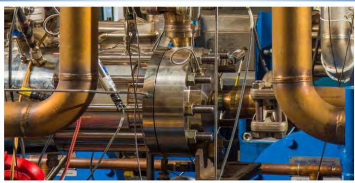
Un detalle de la turbina de dióxido de carbono supercrítico de Sandia National. Científicos norteamericanos han desarrollado un sistema para generar electricidad que, según ellos, **"cambia las reglas del juego"** de la industria: un dispositivo que puede duplicar la producción eléctrica de una central térmica ya sea de combustible fósil, termosolar o nuclear. Ahora, no sólo han demostrado que funciona sino que, por primera vez, **lo han conectado** para inyectar energía a la red.
