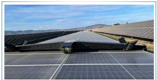
El robot puede moverse en las filas de paneles de forma independiente y no requiere asistencia humana. También es capaz de recargarse mediante paneles solares y volver a su estación de acoplamiento al final de la jornada.
